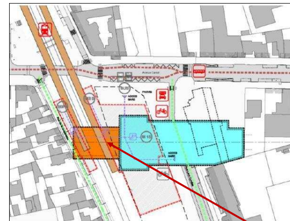
Scénario : construction de la gare depuis la surface et sous dalle ripée (Source : Société du Grand Paris)
