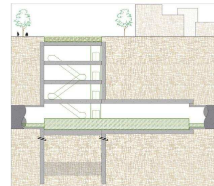
Phase 7 : Reconstruction de la voirie existante. Réalisation des ouvrages intérieurs dans l'ensemble de la gare
